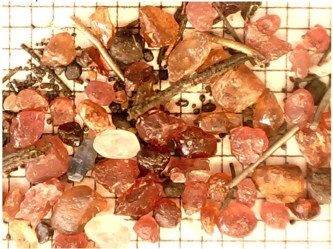
mein Bächel? Habe zwei Sorten Draht, das korrodierte Zeugs ist vermutlich Kupferdraht welcher mal Litzekabel war, weil einige sehr stark aneinanderhängen und nicht magnetisch sind. Die glänzenden Drähte sind hochgradig magnetisch und nicht, noch nicht mal an den Stirnseiten, korrodiert, liegen stets einzeln und sind etwas stärker als die Litzedrähte.
