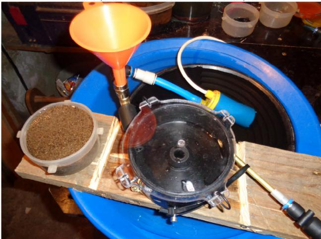
Also hab ich der kleinen Bowl einen Deckel verpasst, mit Gummiringel zum nahezu dichten Verschließen der Schüssel. Das Material wird über den Bypasstrichter direkt in den Wasserstrom gegeben. Man kann kontinuierlich arbeiten. Leert sich die Bowl füllt man einfach wieder nach und aufschwimmende Flitter kann es keine mehr geben.
