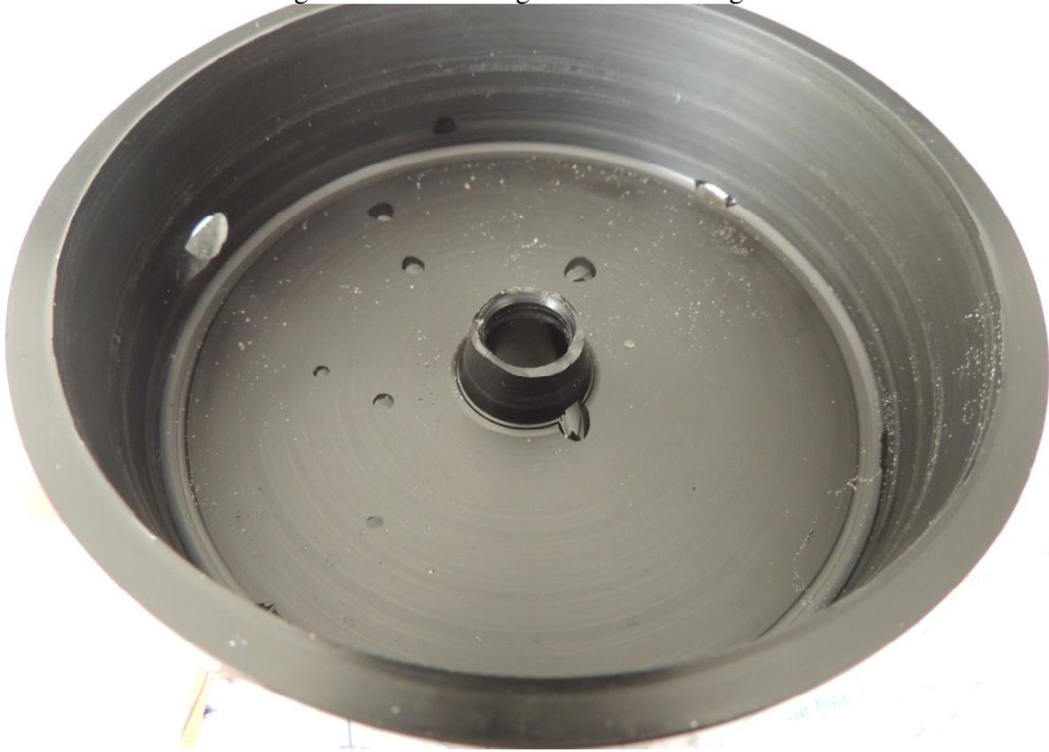
Version 1.1 mit optimierter Düse, Zulaufdrossel, höherer Außenkante und kleinerem Innenloch.
